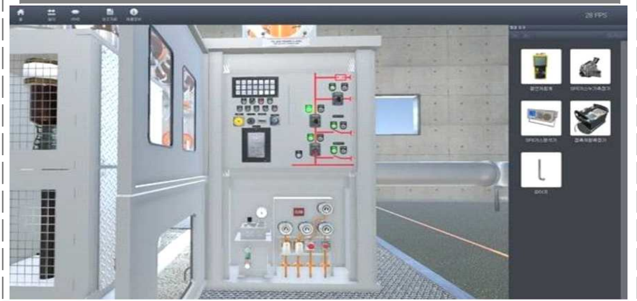
[그림 VI - 1] 전기설비 진단 검사를 위한 시뮬레이터
